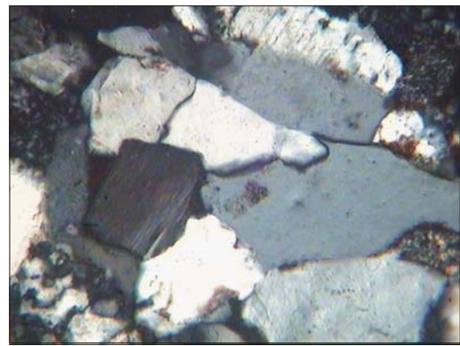
б) уплотнение за счет внедрения зерен (инкорпорационная структура)
